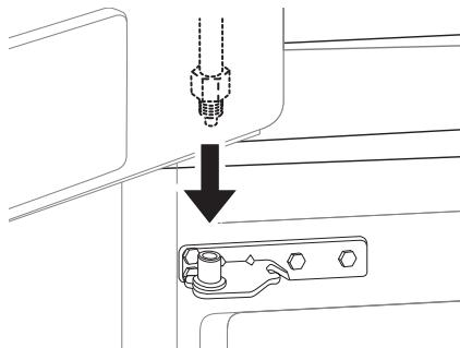
**2** Ajuste la bisagra **1** sobre el picaporte de la manija de la bisagra **2** y encájela en su lugar. Rote la manija **3** en la dirección del reloj y asegure la bisagra.
