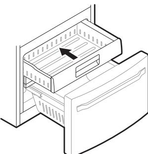
**5** Vuelva a colocar el recipiente de hielo en el estante. Introduzca la canasta Durabase en el montaje del riel.
