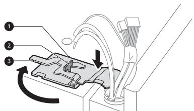
**5** Sujete la conexión de suministro de agua y empuje gentilmente la pinza **4** para conectar las líneas de suministro de agua como se muestra. Introduzca un tubo de al menos 5/8 pulgadas (15 mm) en el conector. Introduzca el clip en el área de unión para asegurar los tubos en su lugar.
