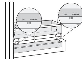
**Removiendo/ensamblando el cajón de verduras con humedad controlada**
