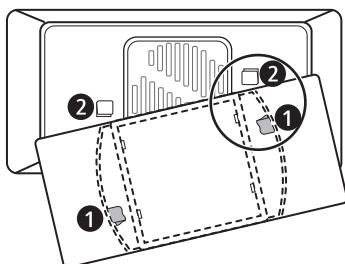
**5** Gire la cubierta del filtro de aire hacia la derecha hasta que los ganchos se acoplen y la cubierta quede fija en su lugar.
