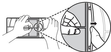
**3** Coloque el filtro nuevo dentro de la cubierta con el lado que dice **FRONT** hacia afuera.
