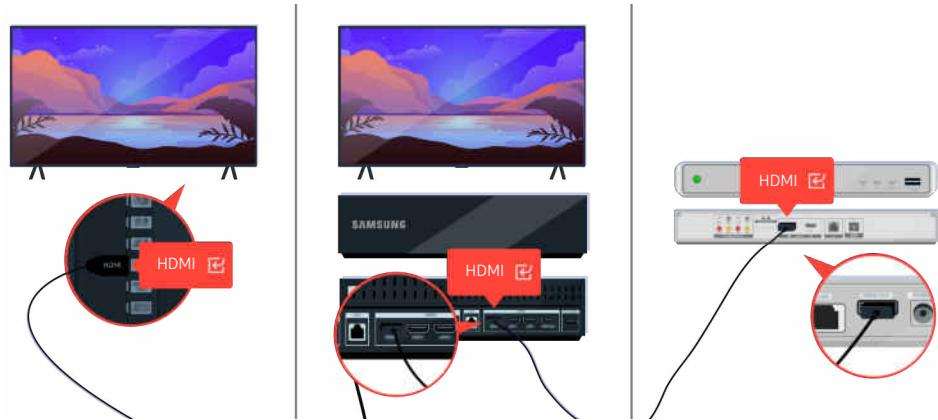
Si le problème persiste, essayez de connecter un autre périphérique au téléviseur au moyen d'un câble HDMI. Si l'image affichée est correcte, c'est peut-être votre périphérique qui est en cause.
