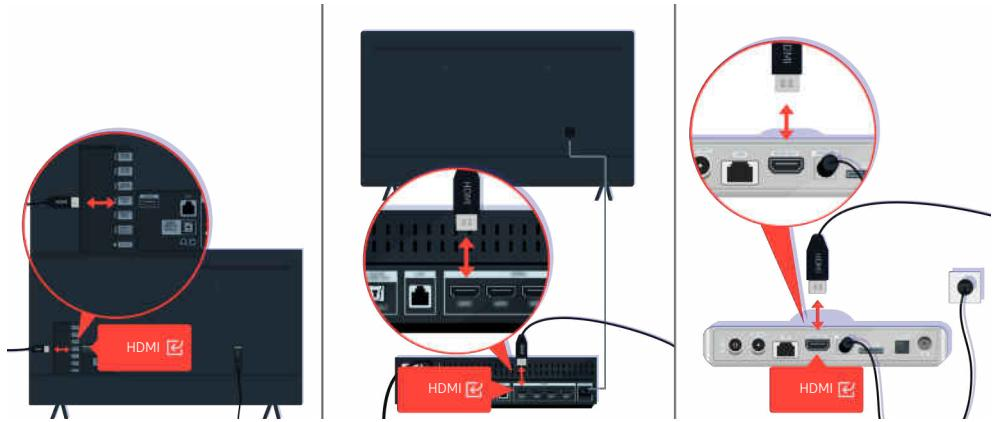
Vérifiez les connexions de l'antenne et du câble HDMI.
