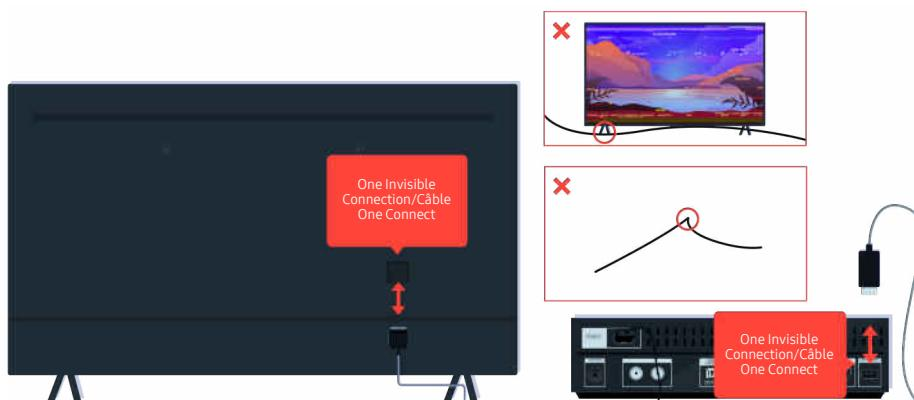
Si le problème persiste, et si votre téléviseur utilise la One Invisible Connection ou le Câble One Connect, déconnectez et reconnectez la One Invisible Connection ou le Câble One Connect dans le téléviseur et le boîtier One Connect. Vérifiez que la One Invisible Connection ou le Câble One Connect n'est pas pincé ou sérieusement plié.
