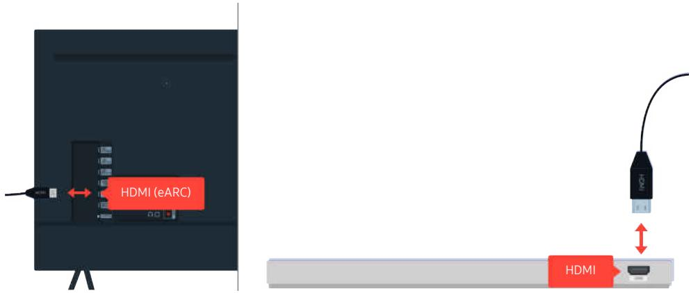
Si la barre de son n'émet aucun son alors qu'elle est branchée au téléviseur au moyen d'un câble HDMI, vérifiez le connecteur HDMI (eARC) situé à l'arrière du téléviseur.
