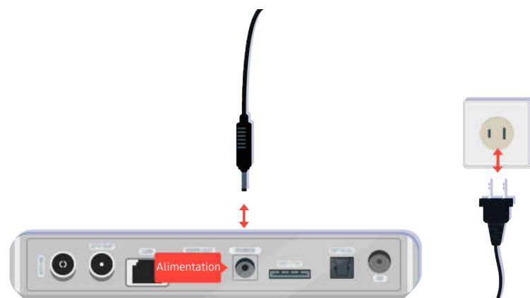
S'il ne peut être mis sous tension, assurez-vous que le câble d'alimentation est correctement branché dans le périphérique et dans la prise murale.
