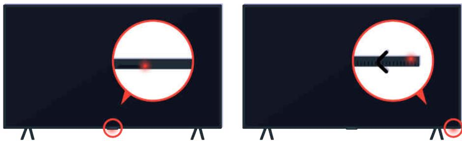
Si votre téléviseur ne peut être mis sous tension, vérifiez si le capteur de la télécommande est activé.
