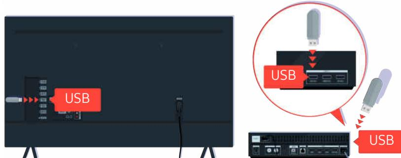
Insérez la clé USB dans la fente prévue à cet effet située à l'arrière de votre téléviseur ou sur le côté du boîtier One Connect.
