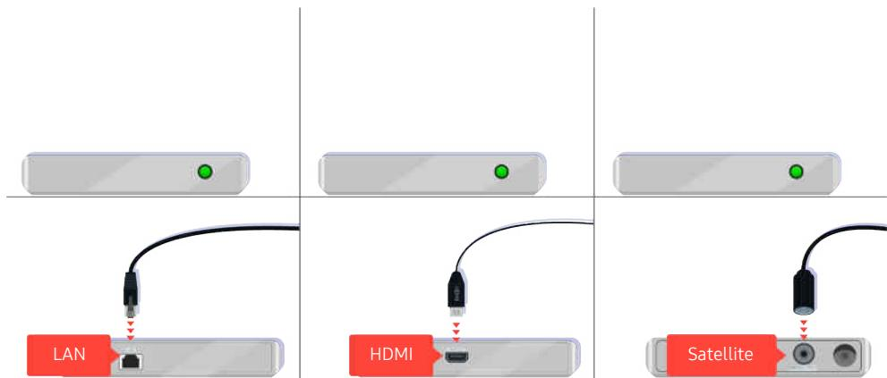
Si vous utilisez un boîtier adaptateur, vérifiez le branchement du câble. Le câble à vérifier variera selon le type de boîtier adaptateur.
