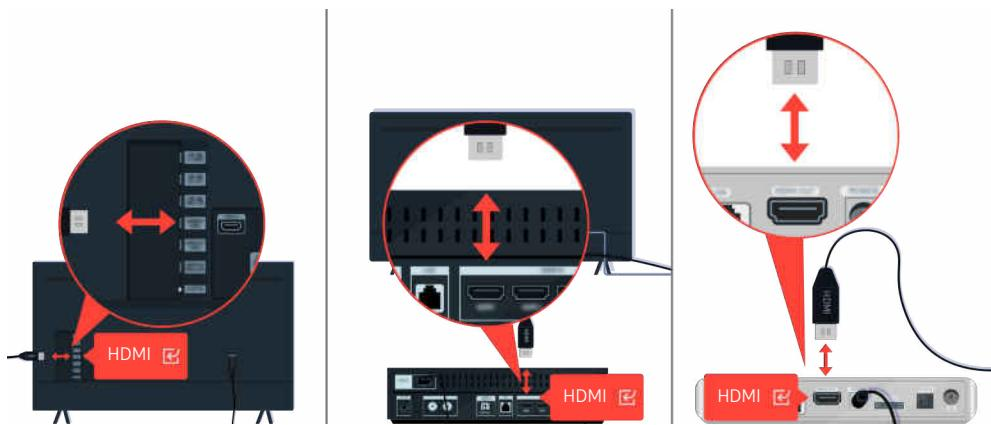
D'abord, débranchez et rebranchez les cordons d'alimentation et les câbles HDMI de l'arrière de votre téléviseur ou du boîtier One Connect, puis débranchez le cordon d'alimentation de la prise avant de le rebrancher.
