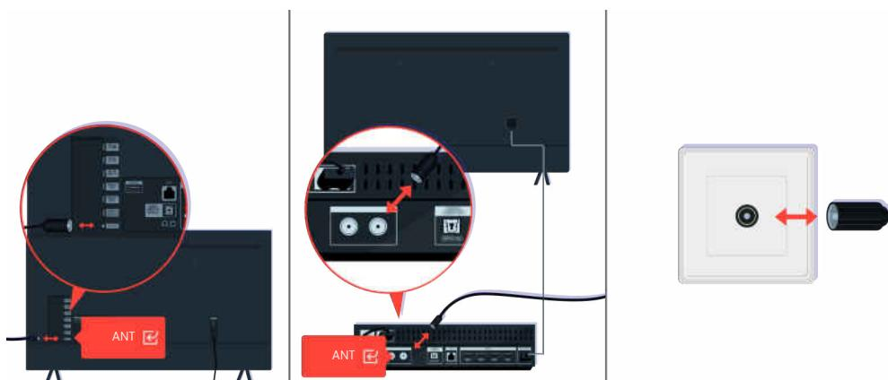
Vérifiez les connexions de l'antenne et du câble d'entrée.
