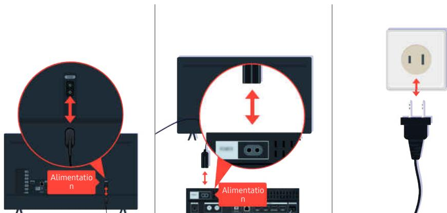
D'abord, débranchez et rebranchez les cordons d'alimentation et les câbles HDMI de l'arrière de votre téléviseur ou du boîtier One Connect, puis débranchez le cordon d'alimentation de la prise avant de le rebrancher.
