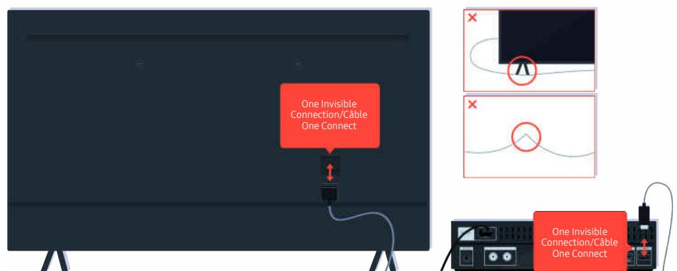
Déconnectez et reconnectez la One Invisible Connection ou le Câble One Connect reliant le téléviseur et le boîtier One Connect. Assurez-vous que la One Invisible Connection ou le Câble One Connect n'est pas pincé ou sérieusement plié.
