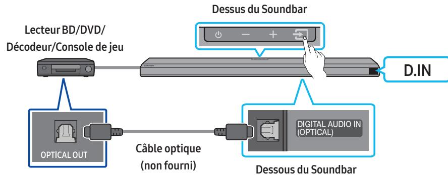
1. Utilisez un câble optique (non fourni) pour connecter le port **DIGITAL AUDIO IN (OPTICAL)** au Soundbar principal et le port **OPTICAL OUT** à l'appareil externe.
