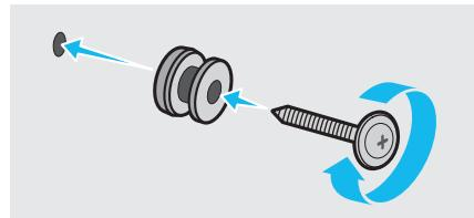
6. Installez les **2 supports muraux** dans le bon sens en dessous du Soundbar à l'aide de **2 vis**.
