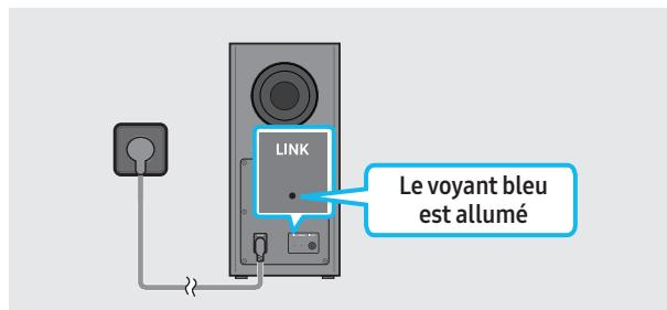
Le voyant **LINK** cesse de clignoter et s'allume en bleu fixe lorsque la connexion est établie entre le Soundbar et le caisson de basses sans fil.
