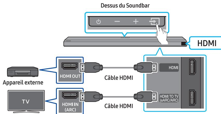
1. Utilisez un câble HDMI pour connecter le port HDMI OUT de l'appareil externe au port HDMI qui se trouve au bas du Soundbar.
