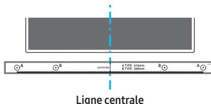
3. Poussez une pointe de stylo ou une pointe de crayon bien taillé au centre des images de **type A** à chaque extrémité du guide pour marquer les trous des vis de support, puis retirez le **guide de montage mural**.
