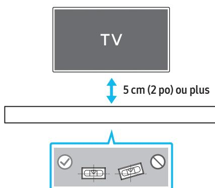
2. Alignez la **ligne centrale** du guide de montage mural sur le centre de votre téléviseur (si vous montez le Soundbar sous ce dernier), puis fixez le **guide de montage mural** au mur avec du ruban adhésif.
