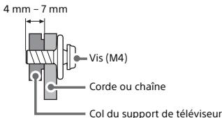
**3** Fixer le téléviseur au mur avec des boulons, un dispositif d'ancrage au mur et une chaîne (ou une corde).
